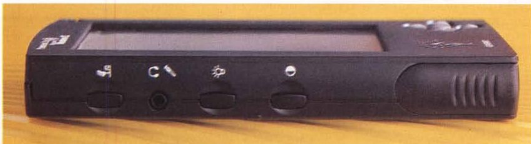
Sul lato sinistro si trovano il tasto per attivare e avviare la registrazione vocale, la presa cuffie, l'interruttore per la scarsa retroilluminazione e lo scomodo tasto per il contrasto.
